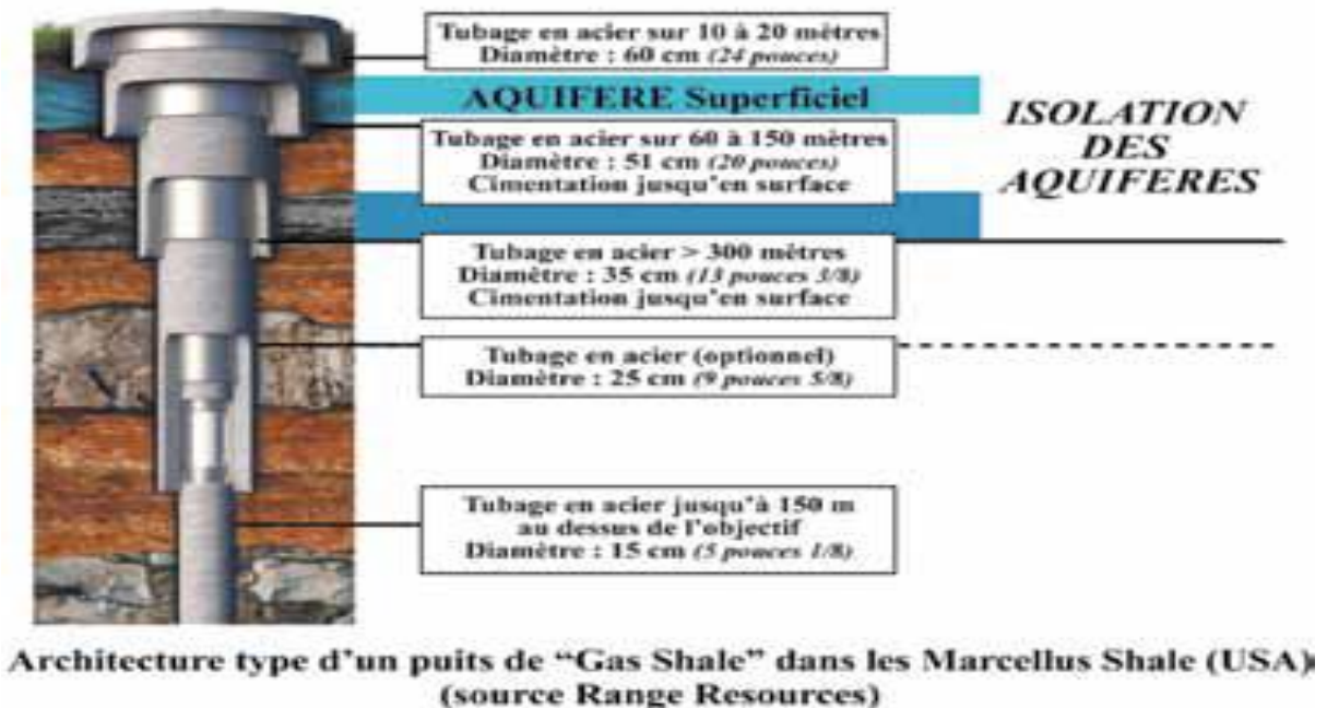
Figure IV.2: Architecture type puits de "Gaz Shale" dans les Marcellus Shale (USA).
