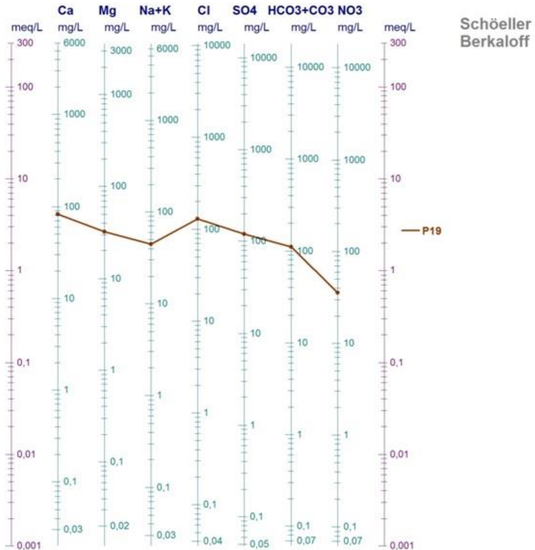
Fig.24 : Diagramme de faciès chloruré calcique des eaux de la nappe de Marhouma.
