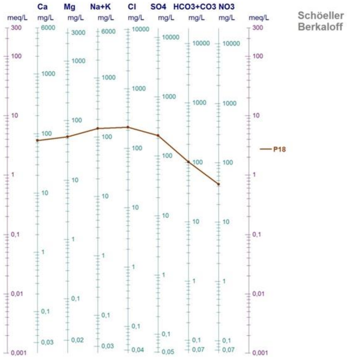
Fig.23 : Diagramme de faciès chloruré sodique des eaux de la nappe de Marhouma.
